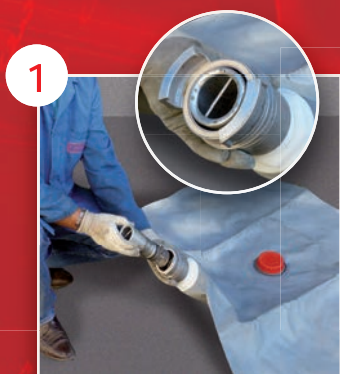
1 Déplier la cuve souple et vérifier que l'ajutage est bien dans son logement
