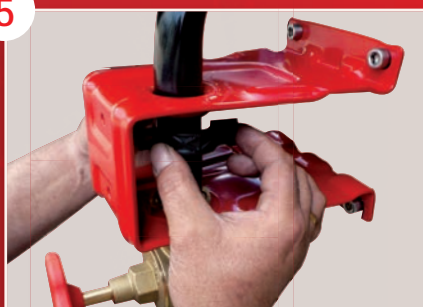
Maintien en position de l'ensemble bobine et tube d'alimentation par un seul collier
